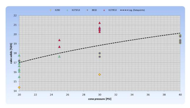
FIGURE 7 - CONE PRESSURE EFFECT ON CAKE SOLIDS
