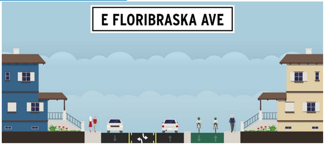
Gráfico de la sección transversal de las mejoras propuestas donde se visualizan los carriles para peatones, vehículos y bicicletas.
